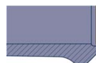
Fig. 3.1: sezione assale Eco Drum con nuovo contorno del lamierino parapolvere.
