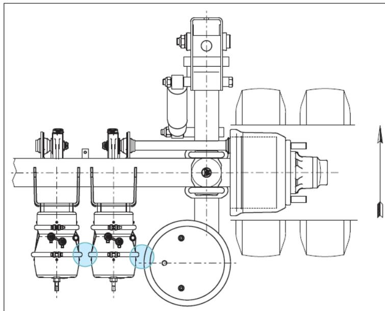
Nel contesto del carrello BPW la lunghezza dell'albero a camme viene determinata dal minimo interasse tra supporti dei cilindri freno e dallo spazio tra i cilindri freno e le molle ad aria (immagine sopra) .
