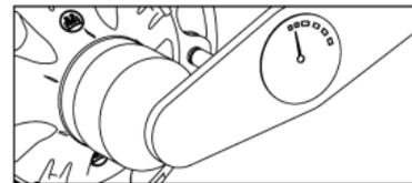
In fase di montaggio e smontaggio fare attenzione a non piegare il magnete con la molla.
