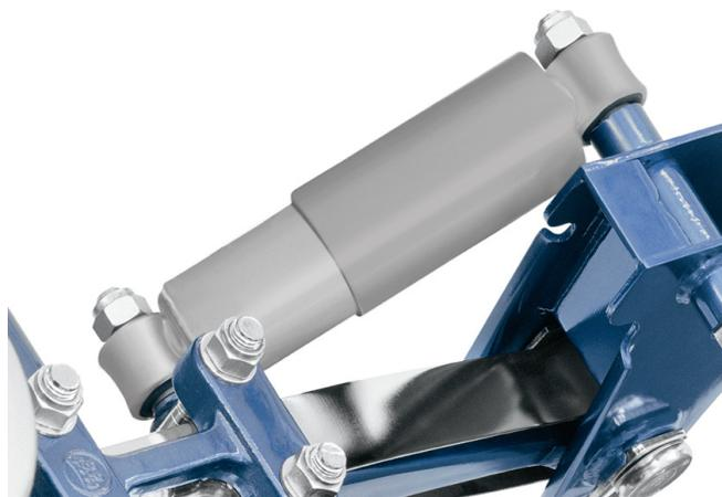
**NB:** Su ciascun assale possono essere montati o sostituiti soltanto ammortizzatori con lo stesso codice. All'interno di un veicolo a più assi è tollerata una dotazione diversa dei singoli assi. L'ammortizzatore **02.3702.52.00** continua a essere disponibile come **ricambio**.
