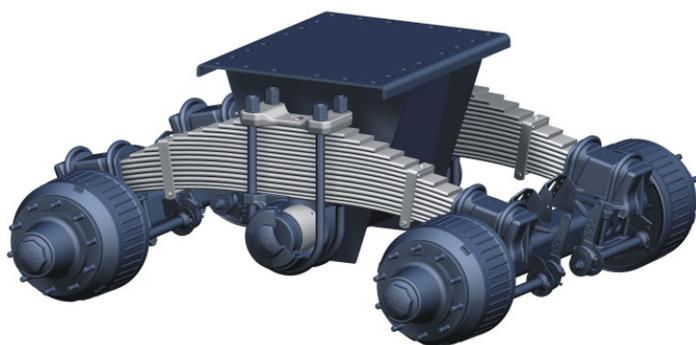
Gli Aggregati-W di BPW sono impiegati per gli utilizzi più gravosi (es. per i terreni difficili o veicoli ribaltabili). Risultano particolarmente validi per questi impieghi grazie soprattutto alla grande corsa di compensazione degli assi. I doppi assali aggregati richiedono una scarsa manutenzione e grazie alla fornitura di un unico pezzo già montato, risultano semplici al montaggio.
