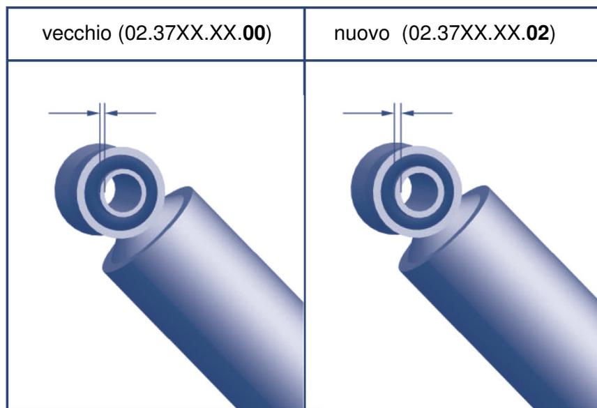
Il fissaggio dell'ammortizzatore al braccio in ghisa ECO Air COMPACT ha bisogno di una coppia di serraggio maggiore rispetto alla già nota esecuzione Airlight II, questo rende necessario un rinforzo della boccola.
