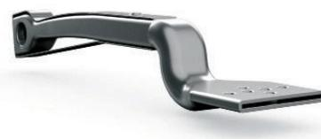
Dopo aver sviluppato il prodotto, avviato la produzione industriale ed eseguito test approfonditi, la LightTube può essere ordinata a partire da inizio 2024, e i clienti BPW possono beneficiare della sospensione pneumatica da 9 t più leggera sul mercato, con un peso del modulo inferiore a 370 kg.
