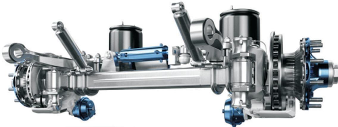
È possibile sterzare in avanti fino ad una velocità di 10 km/h tramite controllo a distanza; pertanto, esso fa sempre parte del nuovo kit di installazione. Ad una velocità superiore ai 10 km/h invece il sistema rimane passivo e l'asse autosterzante riprende la sua normale funzione, controllata tramite connessione EBS. Per garantire la sicurezza funzionale, il sistema EBS del rimorchio dev'essere programmato per velocità fino a 10 km/h.
