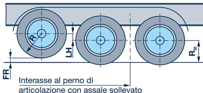
Nelle unità a sospensione pneumatica con sollevatore assale l'altezza di marcia deve essere ridotta ad una contrazione minima di ca. 100 mm per ottenere un'altezza libera da terra sufficiente sotto l'assale sollevato.
