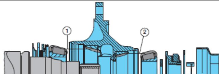
Il sistema cuscinetti ECO<sup>Plus</sup> è predisposto per una lubrificazione a lungo termine:
