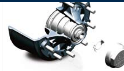
Gestione ottimale: la calotta coprimozzo si sgancia in modo facile e veloce attraverso un innesto a baionetta.
